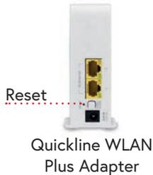
Um den Quickline WLAN Plus Adapter in den Werkszustand zurückzusetzen, drücken Sie für 5 Sekunden den Reset-Knopf (die kleine Öffnung auf der Rückseite). Eine Büroklammer oder ein Zahnstocher eignen sich am besten dafür. Sobald die Zurücksetzung des Quickline WLAN Plus Adapters erfolgt, flimmert die WLAN-Statusanzeige auf der Vorderseite temporär und der Adapter wird im Werkszustand neu gestartet. Dieser Vorgang kann rund 3 Minuten dauern.
