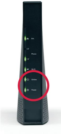
Die erstmalige Inbetriebnahme kann bis zu 20 Minuten dauern – in Ausnahmefällen sogar bis zu 90 Minuten. Das Modem ist betriebsbereit, sobald die Online-, Power-, Up- und Downstream LED Anzeigen konstant leuchten.
